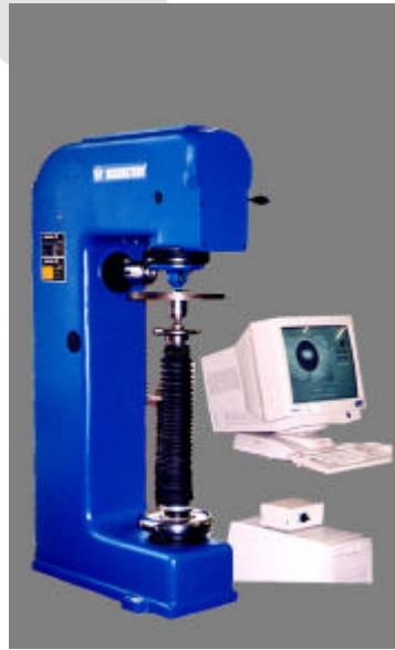
Makrohärteprüfer Diatestor 2n, modernisiert mit CCD Kamera und ecoHARD®
