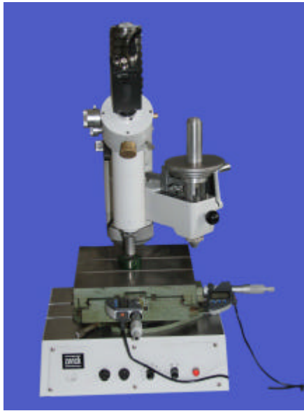
Kleinlasthärteprüfgerät Bauart Zwick, modernisiert mit CCD Kamera und ecoHARD®
